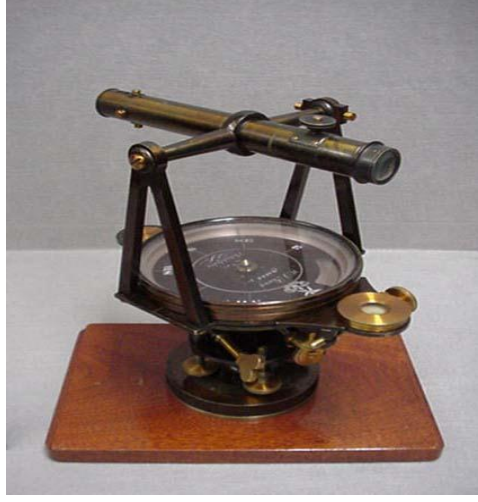
شكل (١٤) : أول جهاز قياس إتجاهات أفقية "Transit"
