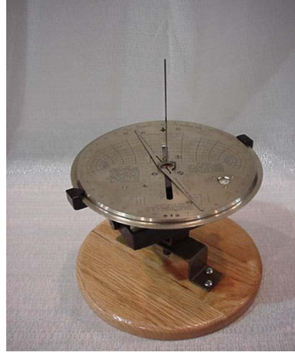
شكل (١٣) : البوصله كجهاز لتحديد انحراف ضلع بالنسبة للشمال المغناطيسي
